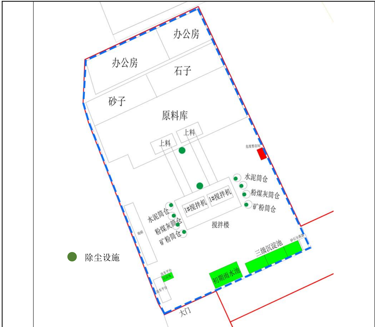
图 4-1 全厂集气、除尘系统结构图
